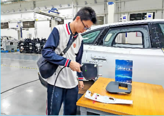
■学子用光学检测仪器检测汽车零件。
