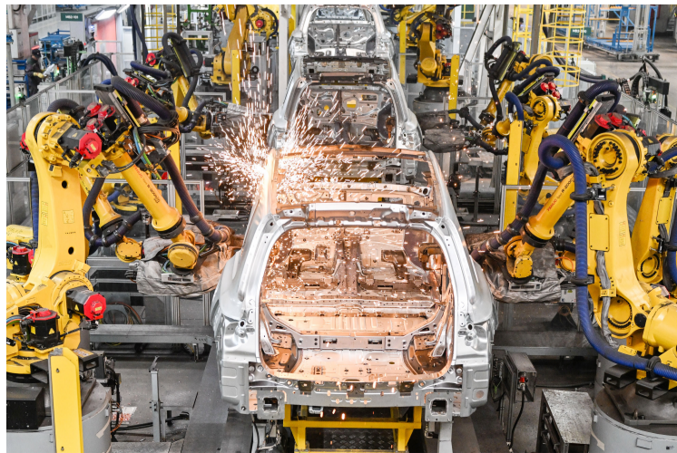
■2024年1月10日,在理想汽车江苏常州基地车间,机械手臂进行焊接作业。
