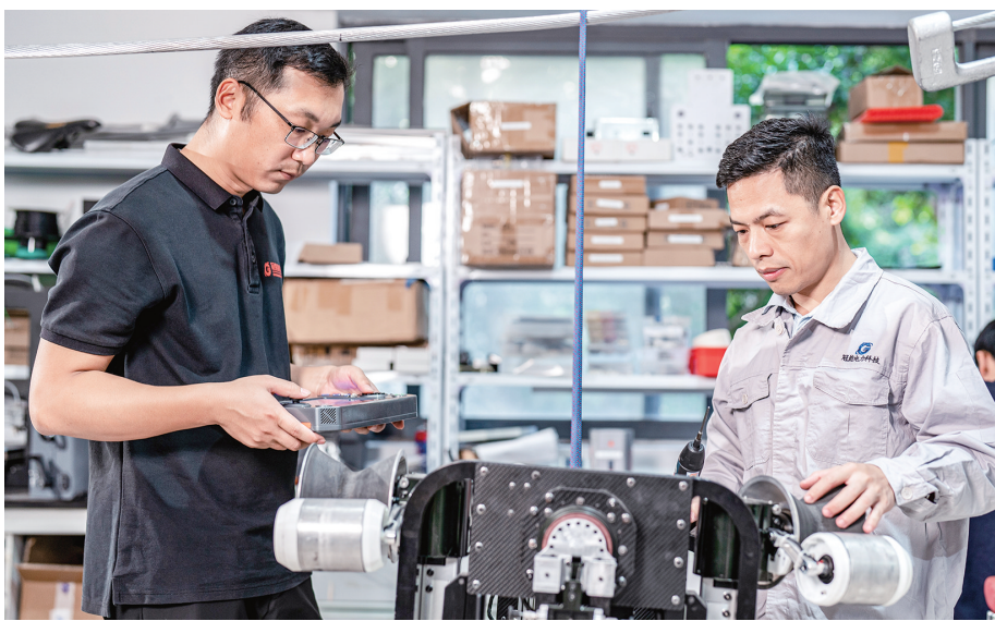
■黄志建（右）检查高压线检测仪摄像头运作情况。
