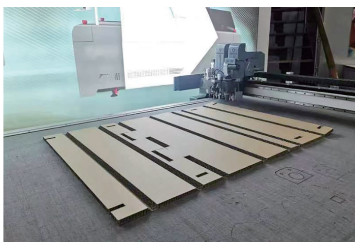
瑞洲数控切割机进行纸板床部件切割。
