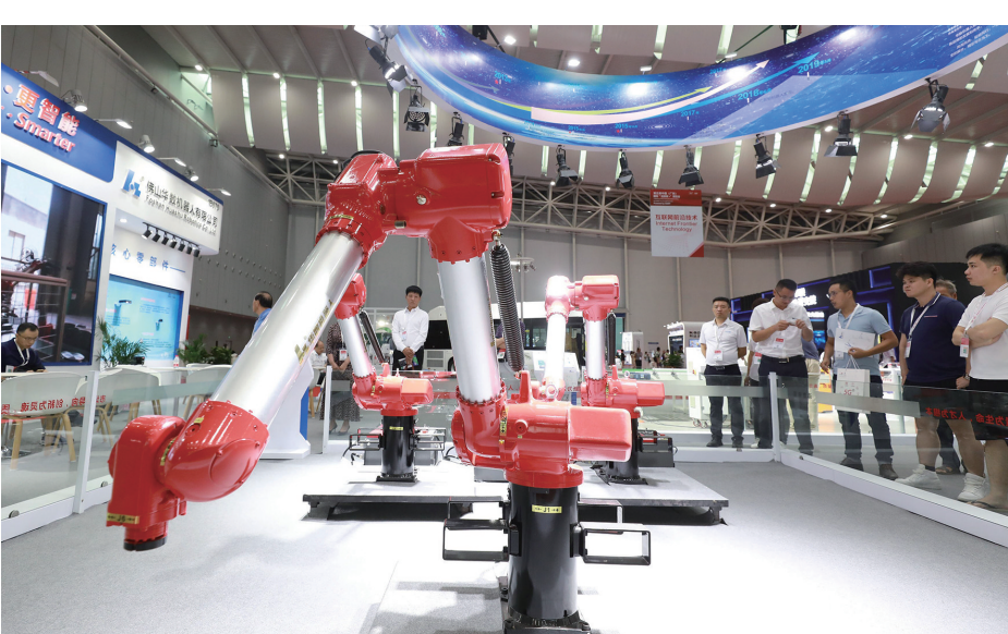
■华数自主研发的HSR-BR双旋系列机器人适用于需要高防护的应用场合。珠江时报记者/方智恒摄
