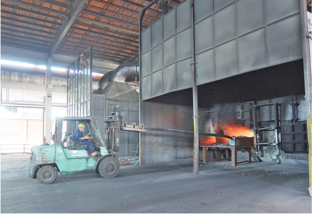
■工人将原料推入熔炉,熔铸铝锭。
