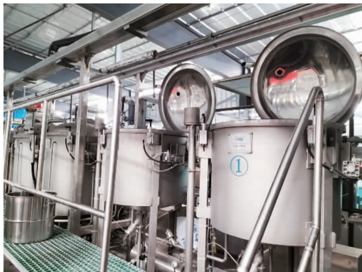
运用染料自动称量系统可实现染料“自动加、及时加、准确加”。
