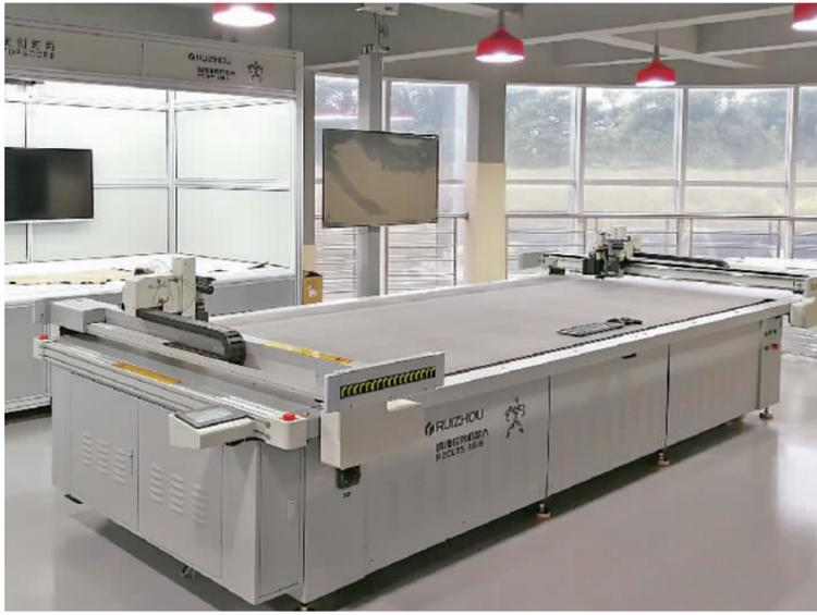
■公司研发的智能切割机可根据皮料图样自动完成排版和切割。
