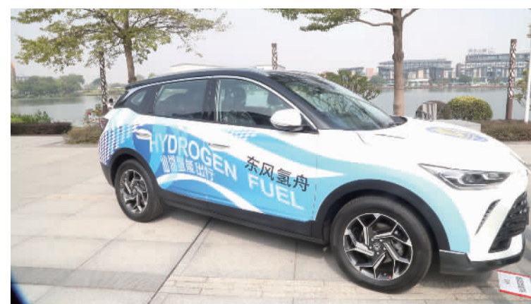
由仙湖实验室展出的氢燃料电池乘用车,续航里程可达500千米。
