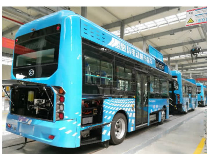
■飞驰新能源汽车有限公司内组装完毕的氢能源公交车。
