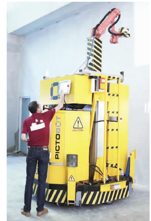
Transforma Robotics 第一代建筑喷漆机器人。
