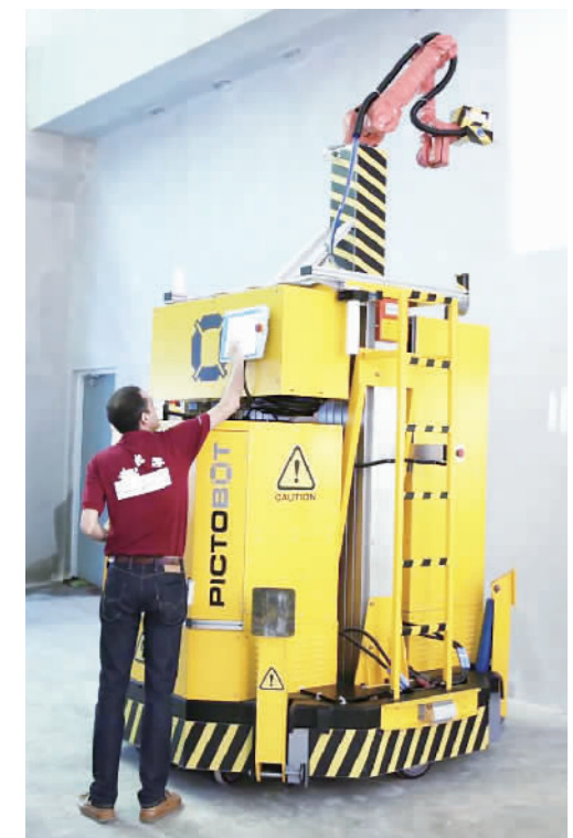
Transforma Robotics 第一代建筑喷漆机器人。
