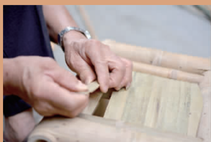
将等宽的竹子插在管通中间,拼成凳面。
